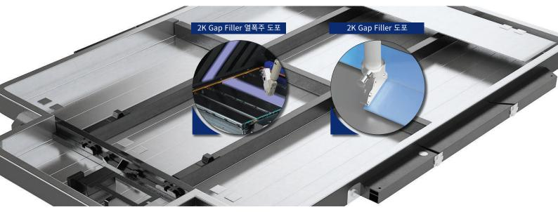
배터리 Cell의 방열,접착,충격에 대한 보호등의 목적으로 Gap Filler, Thermal Adhesive등의 이액형 소재를 정량 및 균일한 형태로 도포하기 위하여 Gap Filler Sealing System를 사용하는 공정입니다.
